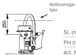
Wenn Mechspace Pro 150 mit einer Vorderbremse ausgestattet ist, und eine volle Hub verwendet wird, muss die Hebevorrichtung abgesenkt werden. (Es kann mit dem Kran kollidieren.)
