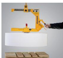
Automatisches Greifen beim Heben
